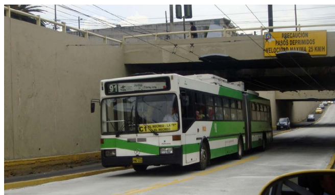
O sistema de tróibus de Quito tem alta capacidade com a circulação em corredor exclusivo e sistema de pré-paga
