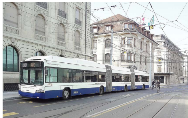
Em Genebra, estão sendo oferecidas diversas linhas de alta capacidade, comparável com (VLT), com 24m de comprimento, trólebus biarticulados e com 4 eixos.
